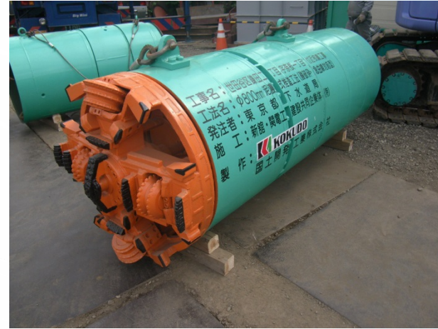
R20急曲線推進工法(東京都)
